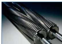
Schneidwellen aus speziell gehärtetem Stahl
